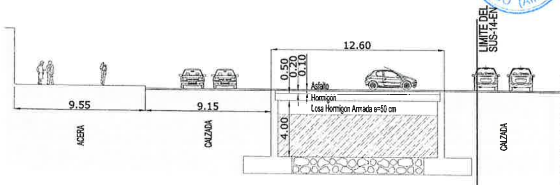
Sección transversal de la rambla de Los Aljibillos (ROTONDA).
